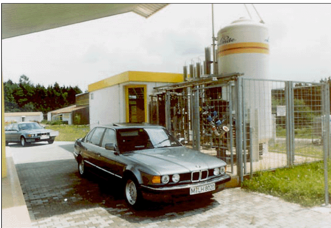
Abb. 4: Betankungsserie von LH 2 -Versuchsfahrzeugen
